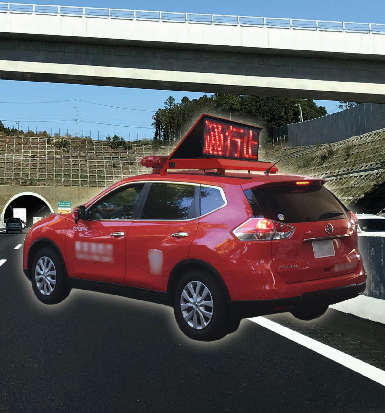
厚さわずか 112 mmのボックスに表示寸法 320 mm × 960 mmと大型の高輝度表示板を格納しており、コントローラー操作により 4 秒ほどで自動開閉する LED 情報板です。
