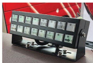
16スイッチコントローラー 台座設置
