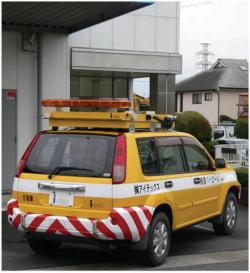
320 mm角の薄型表示ユニットを縦 4 枚、横 3 枚の合計 12 枚使用し、縦 1,280 mm × 横 960 mmの大型表示面で遠距離からの視認性に優れています。
