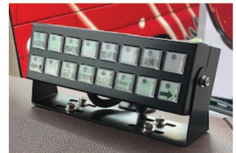
16スイッチコントローラー 台座設置
