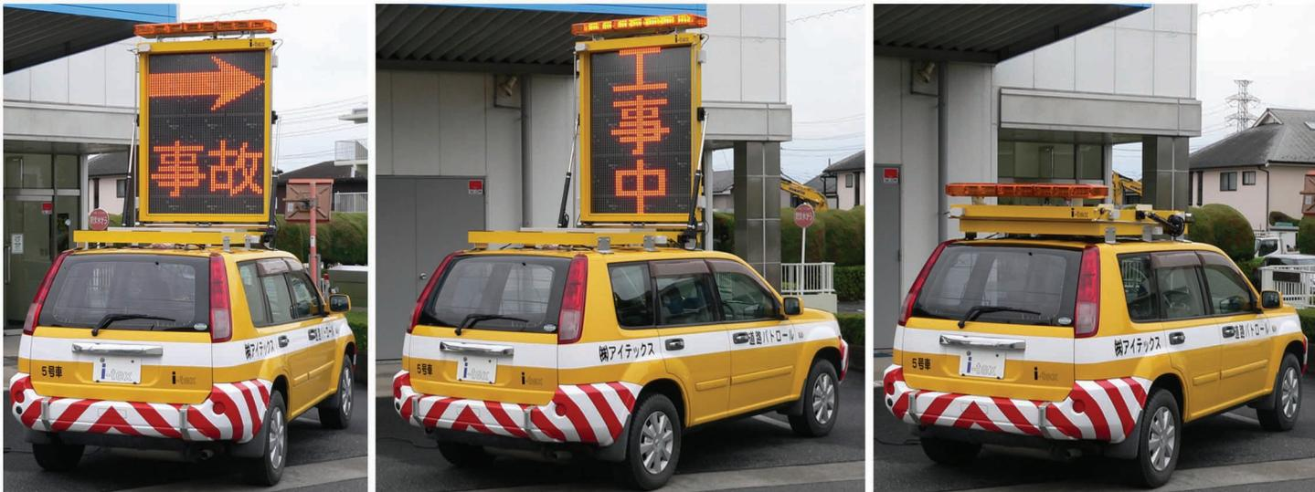
320 mm角の薄型表示ユニットを縦 4 枚、横 3 枚の合計 12 枚使用し、縦 1,280 mm × 横 960 mmの大型表示面で遠距離からの視認性に優れています。
