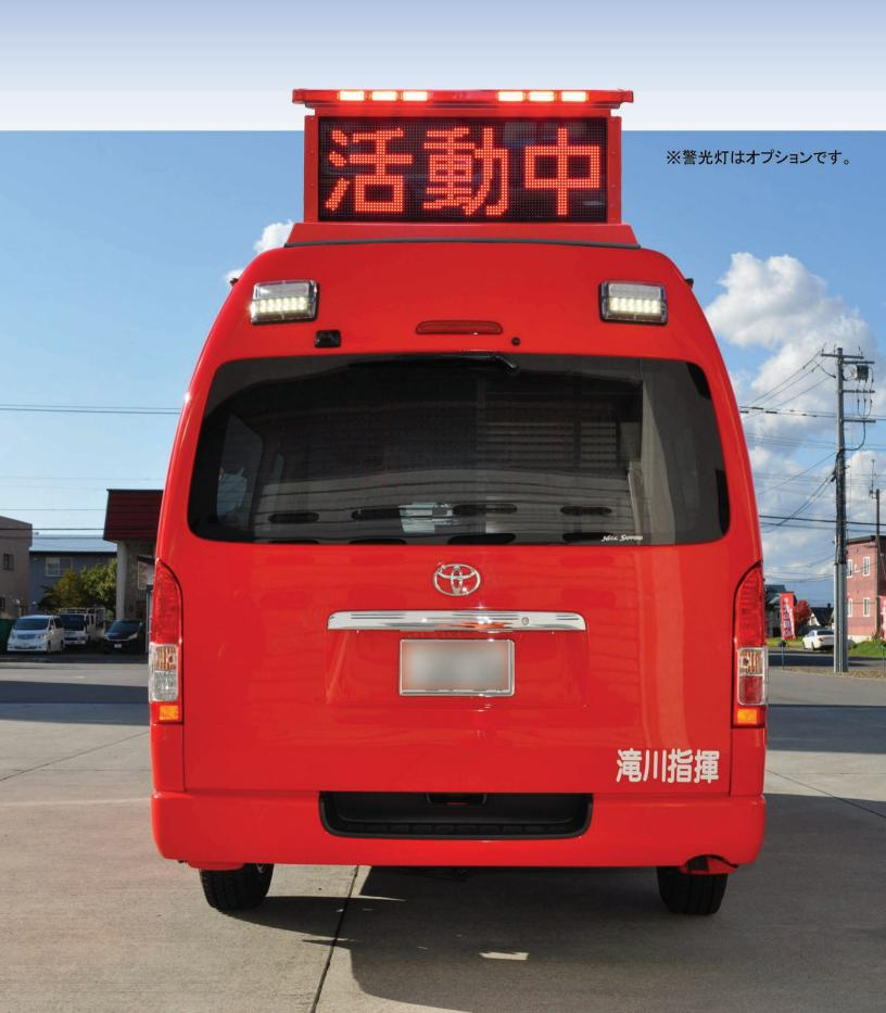
軽量化されたアルミボディに高輝度フルカラーLEDをセットした車両搭載型のルーフサインです。 縦 32×横 96 ドットのフルカラーLEDにより、6 色の多彩な表示を可能とします。
