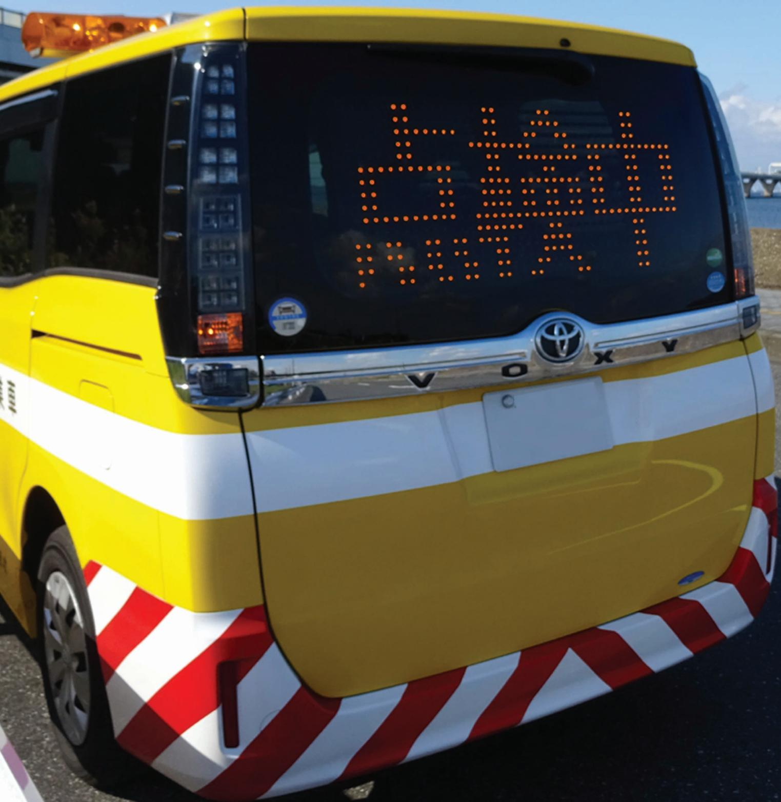
車内のリアウインドウに設置し、LEDの発光により道路使用者や車両へ安全などに対する注意喚起、情報伝達する情報板です。
